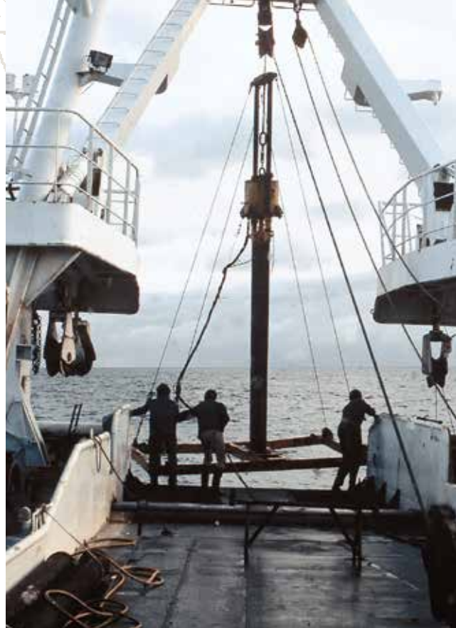
▲ Fig. 5 : Carottier pour les sédiments meubles du plateau continental.
