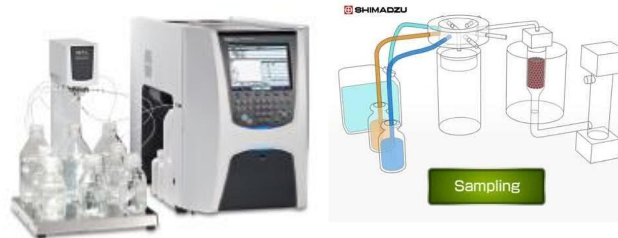
L'instrument est capable de mesurer le carbone total, inorganique et non purgeable par le biais d'une combustion à 680°C et/ou d'une attaque acide ( $\text{H}^3\text{PO}_4$ ). Cet outil permet de réaliser l'analyse du carbone dans l'eau et dans le sédiment.
