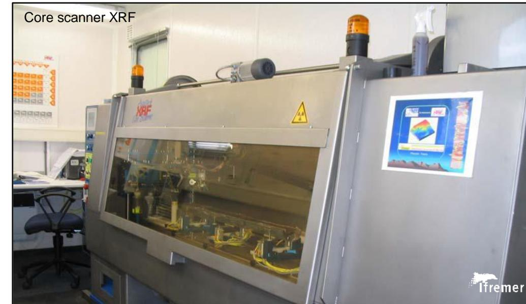
*La spectrométrie à fluorescence X consiste à irradier un échantillon par un RX primaire. L'atome est dans un état excité et retourne à un état stable (restructuration de ses couches électroniques) en émettant un rayonnement secondaire caractéristique dit de fluorescence X.*
