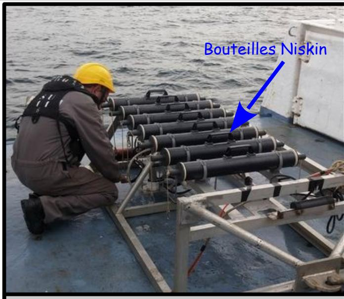
L'objectif du préleveur étagé est de déclencher à partir du navire la fermeture des 7 bouteilles simultanément. Une "tranche d'eau" est collectée ce qui permet d'avoir une photographie instantanée de la composition en gaz de cette eau.
