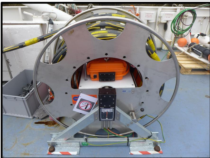
La flûte sismique correspond au **récepteur**. Celle-ci est enroulée sur un touret, sur une longueur totale de 150 m, dédiée à l'acquisition sismique plateau. Elle est constituée d'hydrophones qui vont enregistrer les signaux acoustiques.
