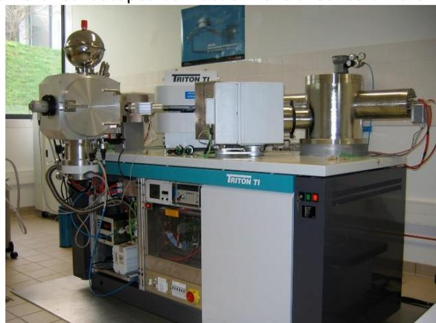
*Spectromètre de masse à thermo ionistaion (TI-MS) Triton. Photo du PSO (pôle Spectrométrie Ouest)*
